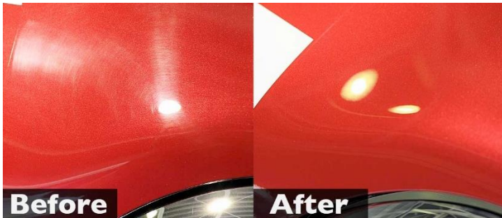
◆安価なコーティングを謳う施工店や業者の中には、そもそも下地作りを省略してコストカットしたり、キズをシリコン等の油分で埋めて消す「研磨もどき」を行い一時的にキレイに見せている場合がありますので、ご注意ください。
